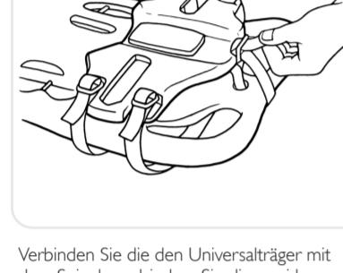
Verbinden Sie den Universalträger mit dem Spineboard, indem Sie die zwei langen Bänder und das kurze Band verwenden und einfädeln.
